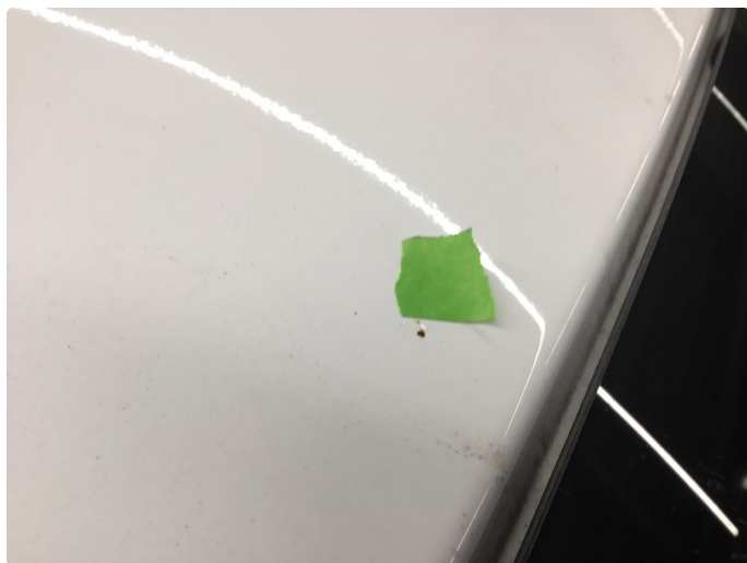
1.2 Steinsprut i lakken på taket, penselflekket.
