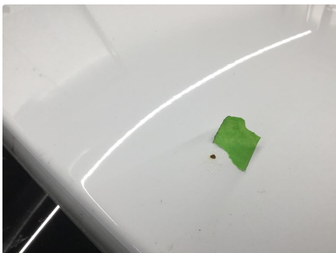
1.2 Steinsprut i lakken på taket, penselflekket.
