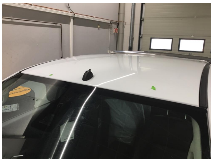
1.2 Steinsprut i lakken på taket, penselflekket.
