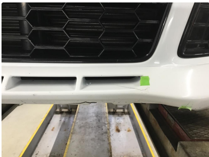
1.3 Sprekker i støtfanger foran i underkant.
