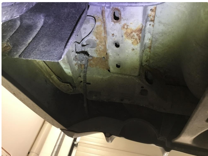
1.2 Noe rust oppunder bakstilling/karosseri. Anbefaler understellsbehandling.
