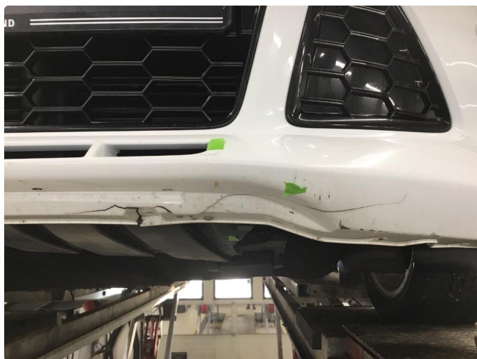
1.3 Sprekker i støtfanger foran i underkant.
