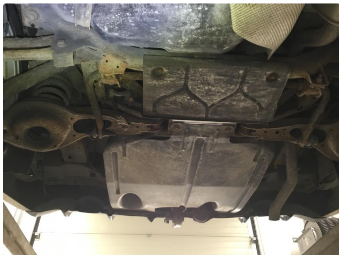
1.2 Noe rust oppunder bakstilling/karosseri. Anbefaler understellsbehandling.
