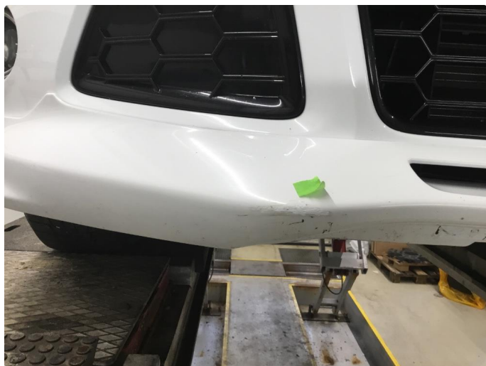
1.3 Sprekker i støtfanger foran i underkant.
