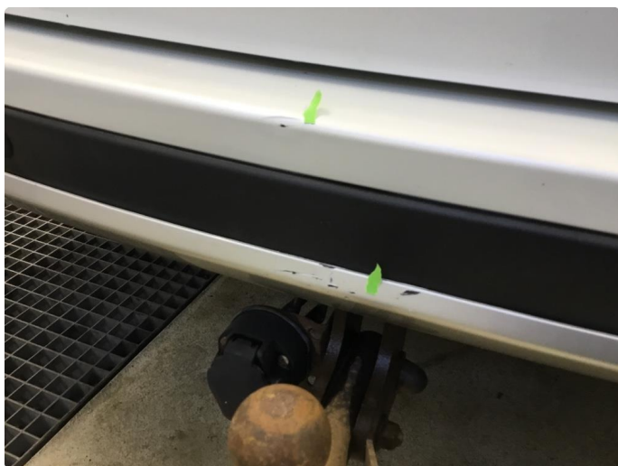
1.3 Noe riper/bruksslitasje i lakken støtfanger bak, samt en liten bulk i den svarte plasten til høyre for midtre h.parksensor.
