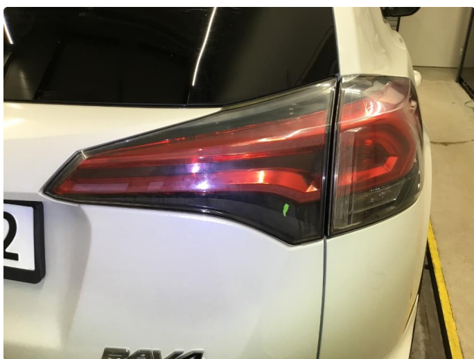
2.1 Innvendig belegg baklamper.
