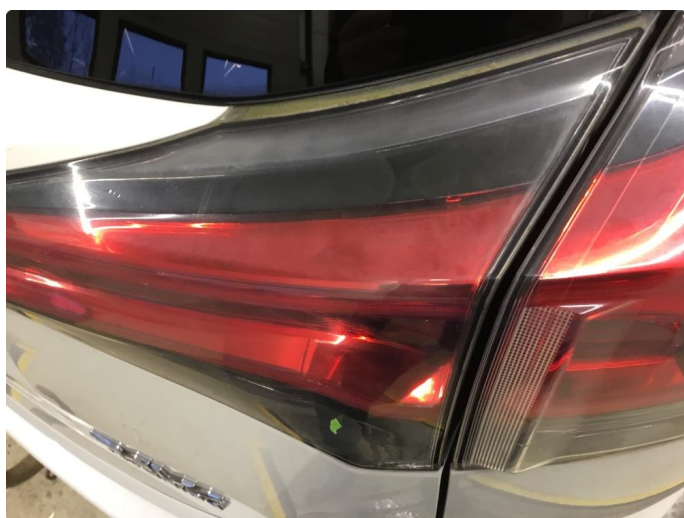
2.1 Innvendig belegg baklamper.
