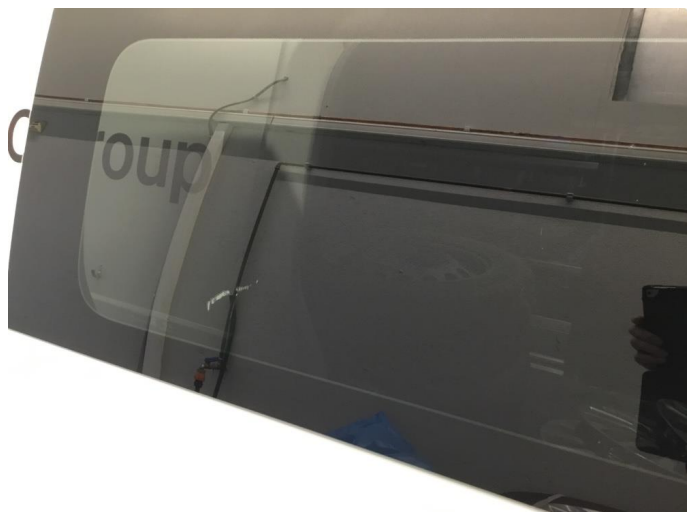
1.3 Rift i sotfilm høyre skyvjør.
