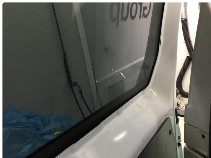
1.3 Rift i sotfilm høyre skyvjør.
