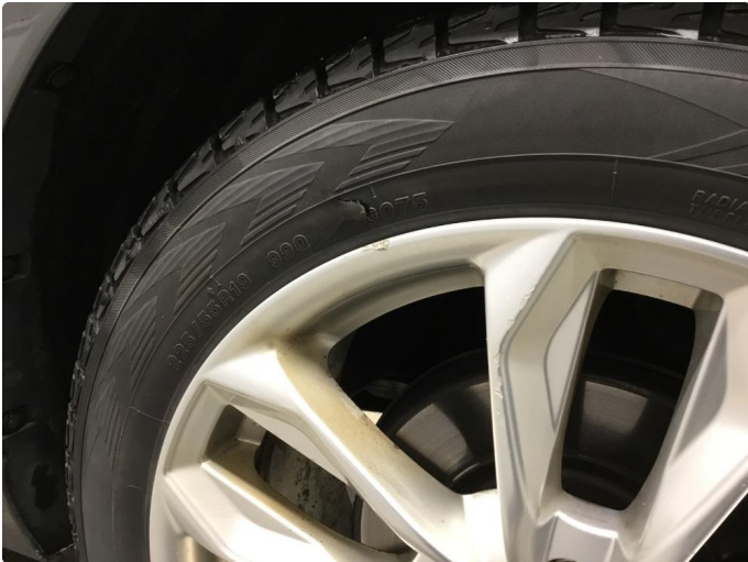
1.2 Liten skade vinterfelg/dekk h.foran. Skade dekk er ikke igjennom gummi, kun i yttre gummilag.
