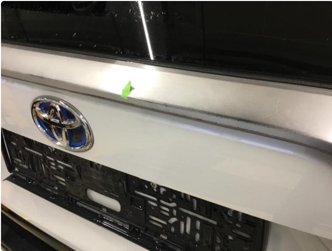
1.2 Noe lakkslitasje sølvlist bakluke.
