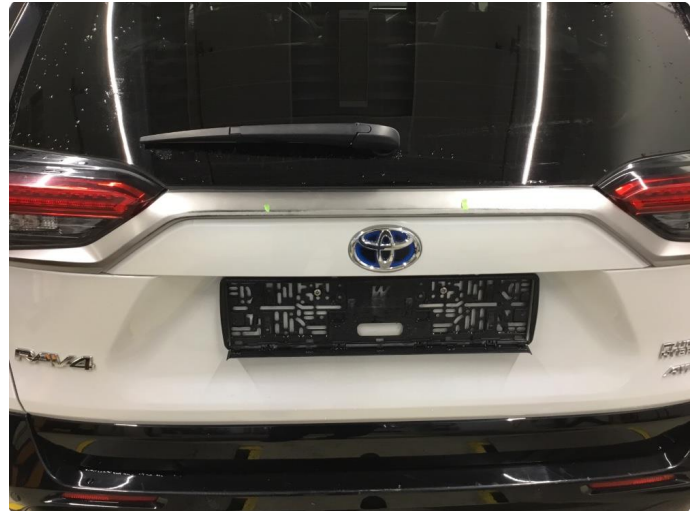
1.2 Noe lakkslitasje sølvlist bakluke.
