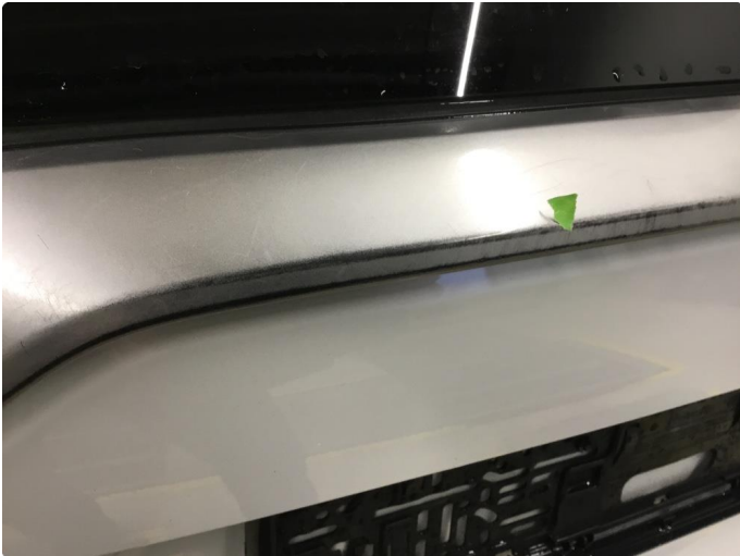
1.2 Noe lakkslitasje sølvlist bakluke.
