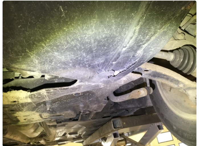
1.1 Noe skade/sprekker i søleplate under motor.
