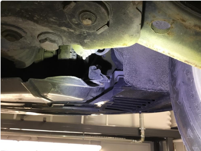
1.1 Noe skade/sprekker i søleplate under motor.
