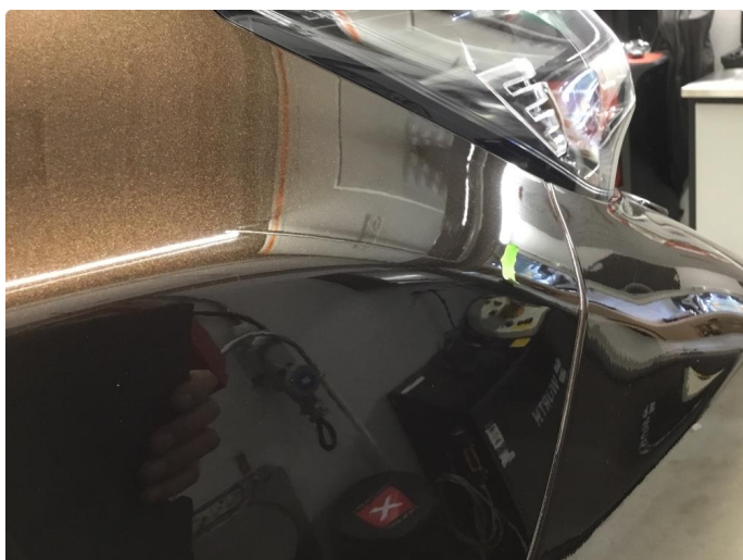
1.3 Bulk uten lakkskade framkant høyre forskjerm. Smartrep. Skal utbedres
