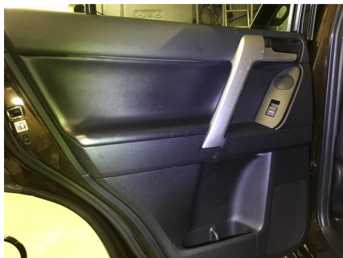
3.1 Mye riper/bruksslitasje alle 3 dørtrekk i varerom, samt rift i skinnet på dørtrekk høyre bakdør.
