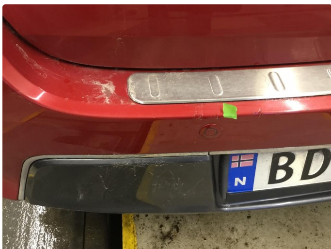
1.2 Liten klemskade i plast fanger bak.
