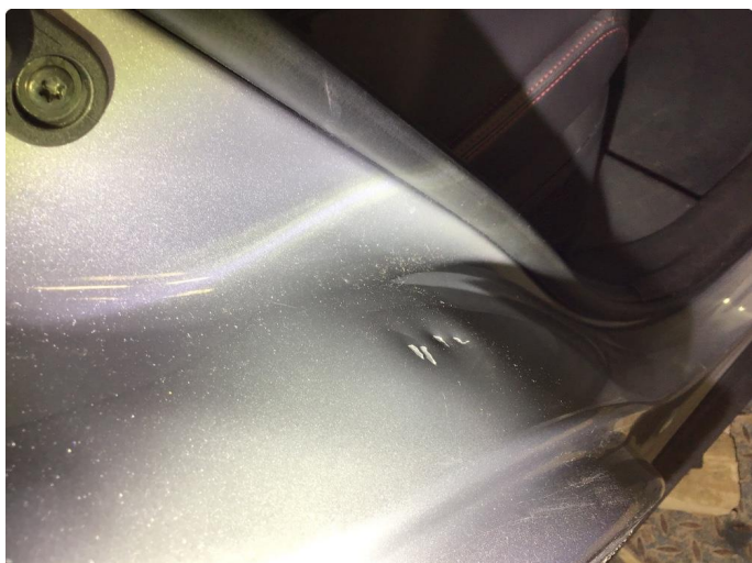
1.2 Noen små bulker på innsteg bakdør hs.
