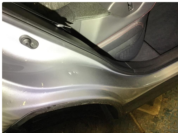
1.2 Noen små bulker på innsteg bakdør hs.
