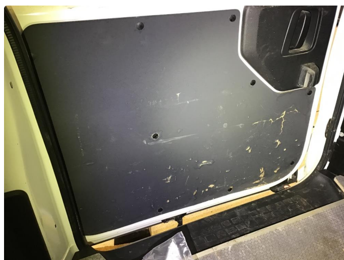
2.1 Skiftet innv trim på begge skyvedører.
