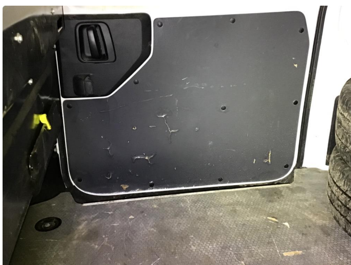
2.1 Skiftet innv trim på begge skyvedører.
