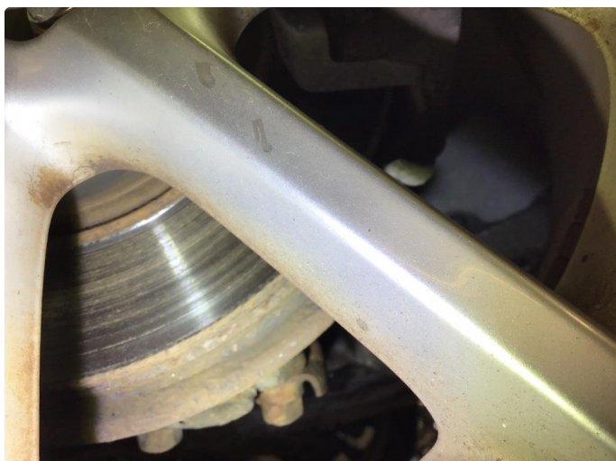
3.1 Skiftet bremseskiver og klosser foran, bremsklosser bak og bremsørør bak begge sider.
