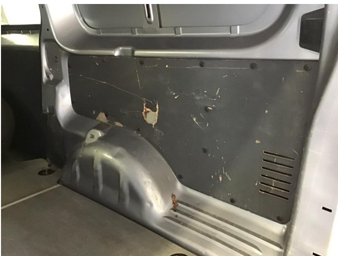
2.1 Noe brukslitasje på innv dørtrekk i varerom.
