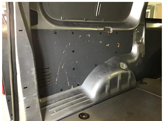
2.1 Noe brukslitasje på innv dørtrekk i varerom.
