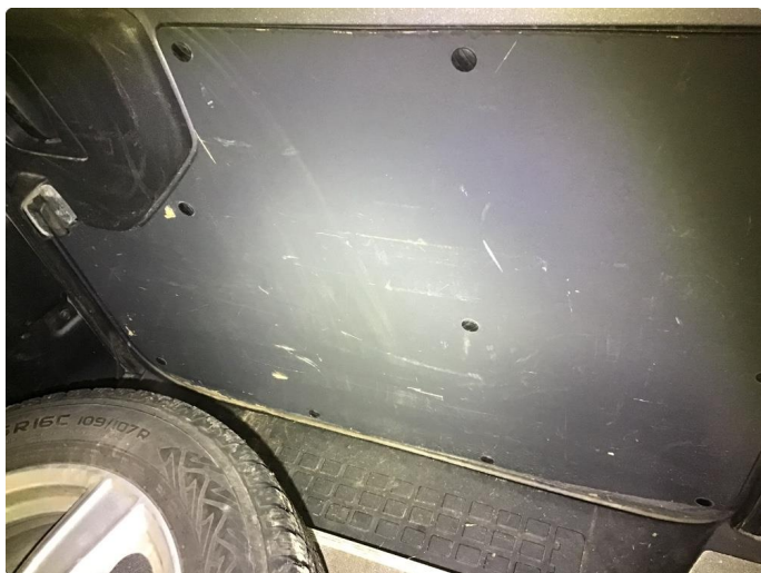
2.1 Noe brukslitasje på innv dørtrekk i varerom.
