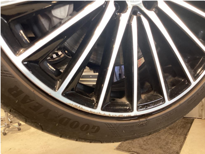
1.1 Ubetydelig bruksmerke felg etter kantkjøring
