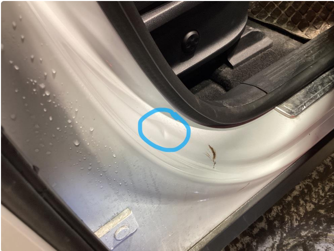
1.1 Liten bulk på innsiden av en dør
