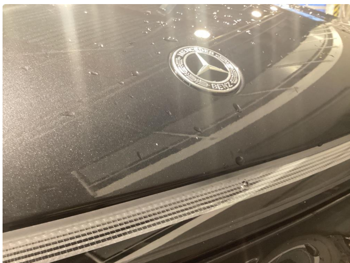
1.1 Noe steinsprut på panser
