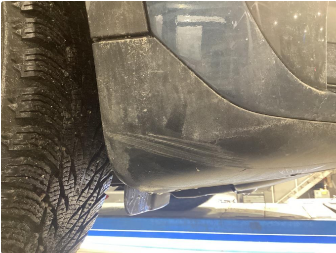
1.1 Ubetydelige skrubbskader underkant
