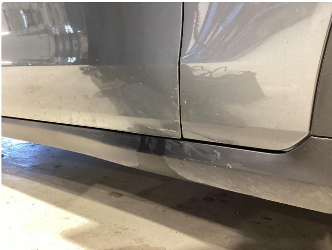
1.1 Skade uten lakkskade på dør
