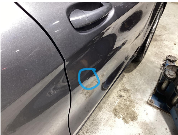
1.1 En del riper og lakkslitasje
