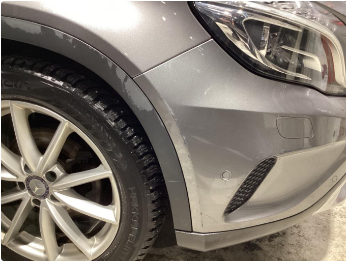
1.1 En del riper og lakkslitasje
