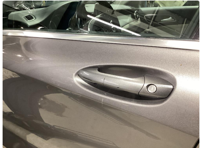
1.1 En del riper og lakkslitasje
