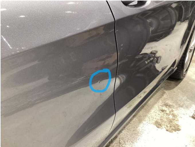
1.1 En del riper og lakkslitasje
