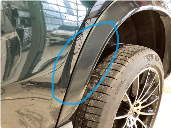
1.1 Noe matt lakk på hjulbue
