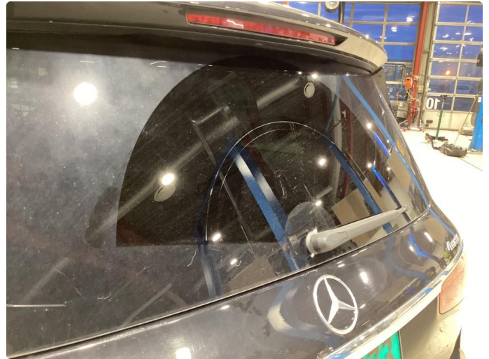
1.2 Slitasje etter vindusvisker bak
