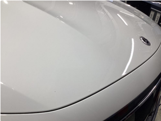
1.1 Små stensprut på panser
