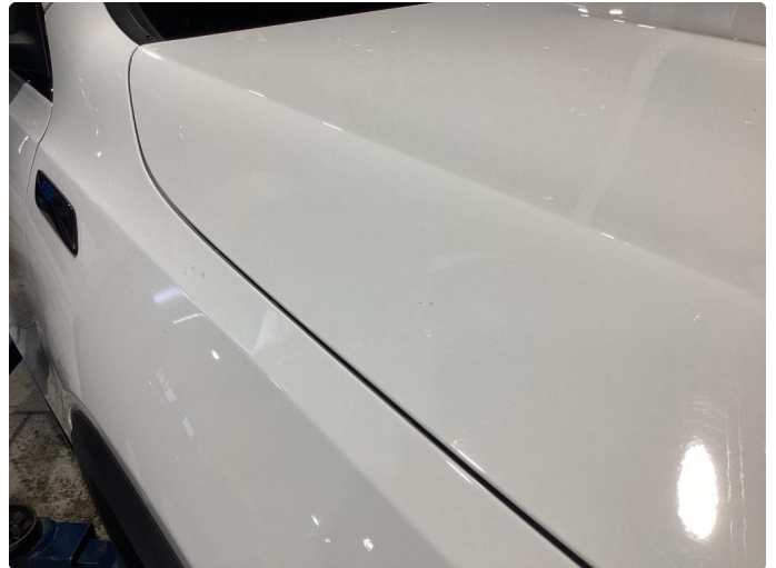
1.1 Små stensprut på panser
