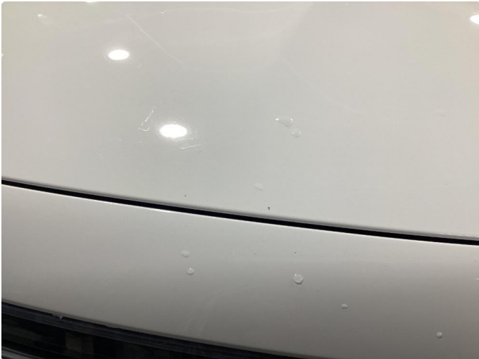
1.1 Små stensprut på panser
