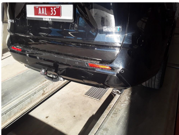
1.4 Riper på støtfanger bak.
