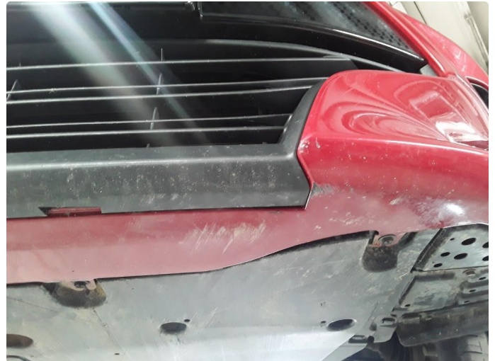
1.3 Skrubbskader underkant av støtfanger
