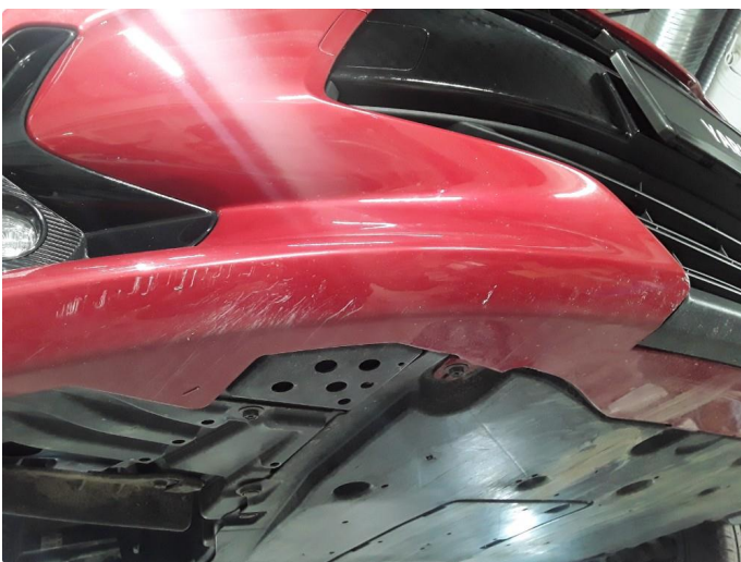
1.3 Skrubbskader underkant av støtfanger
