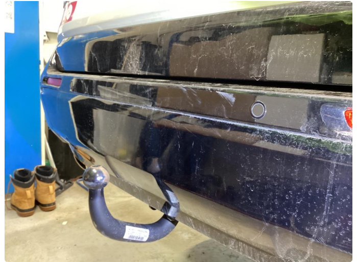
1.1 Bruks slitasje på støtfanger bak.
