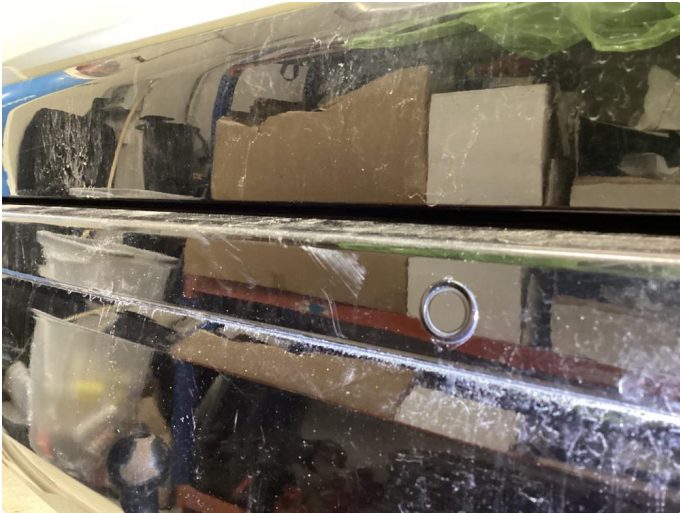
1.1 Bruks slitasje på støtfanger bak.
