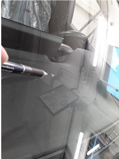
1.1 Steinsprut - Er reparert.
