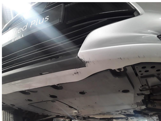
2.1 Skrubbskader underkant på støtfanger.
