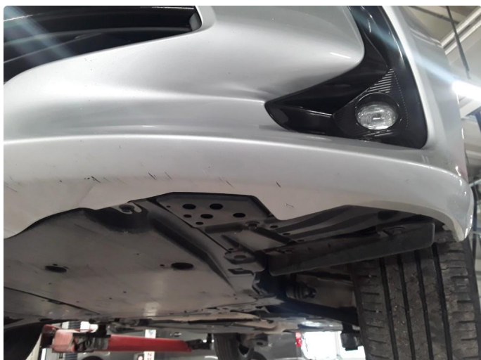
2.1 Skrubbskader underkant på støtfanger.
