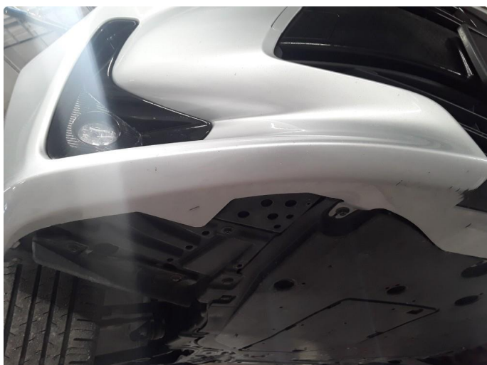
2.1 Skrubbskader underkant på støtfanger.
