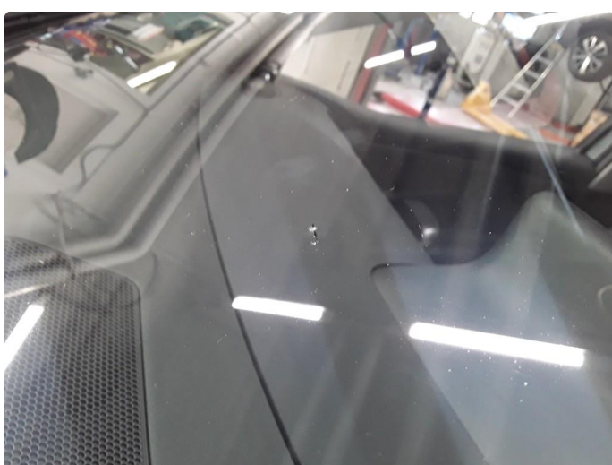
2.2 Små steinsprut i frontrute.
