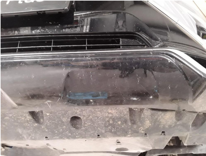
1.1 Små skrubbskader underkant støtfanger foran.
