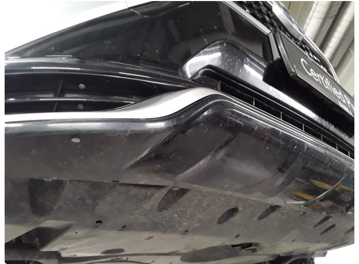
1.1 Små skrubbskader underkant støtfanger foran.
