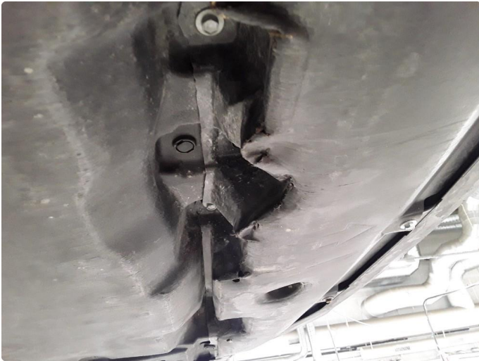
1.1 Beskyttelsesplate under bilen har riper/små skader
