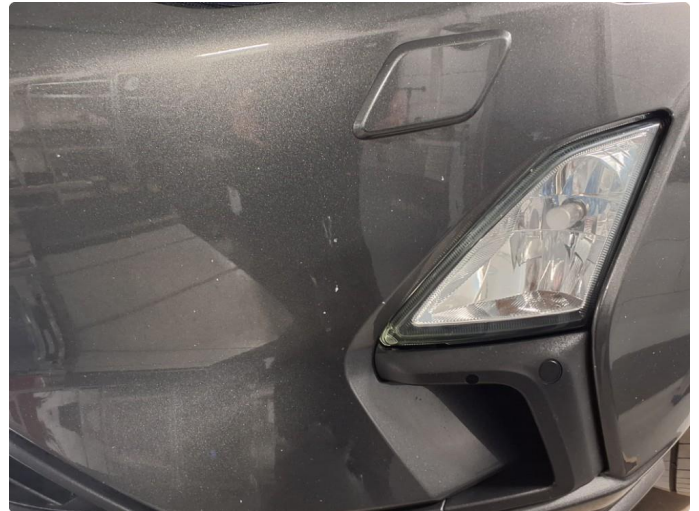
1.2 Steinsprut på støtfanger foran.
