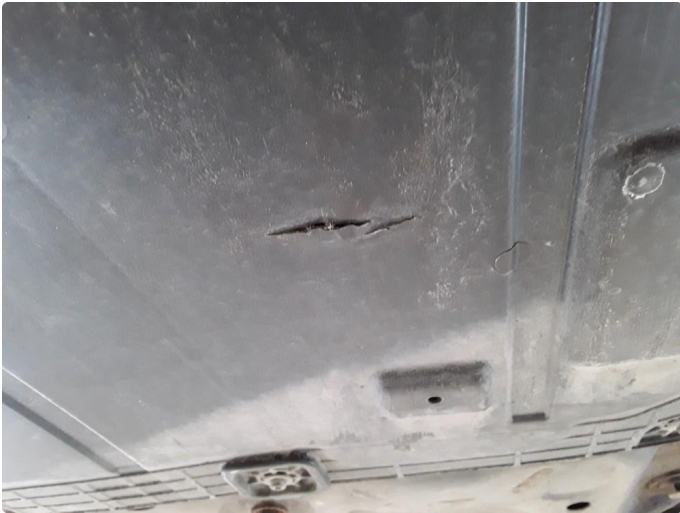
1.1 Liten rift i beskyttelses deksel under bilen
