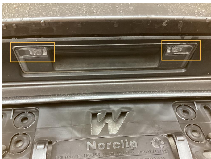
2.1 Krakelering i plast. Byttet
