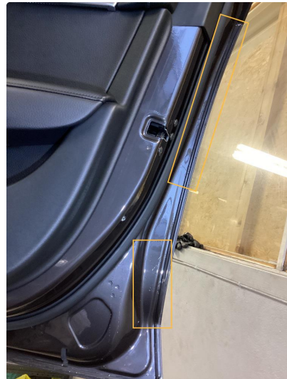
1.2 Rust i fals. Utført
