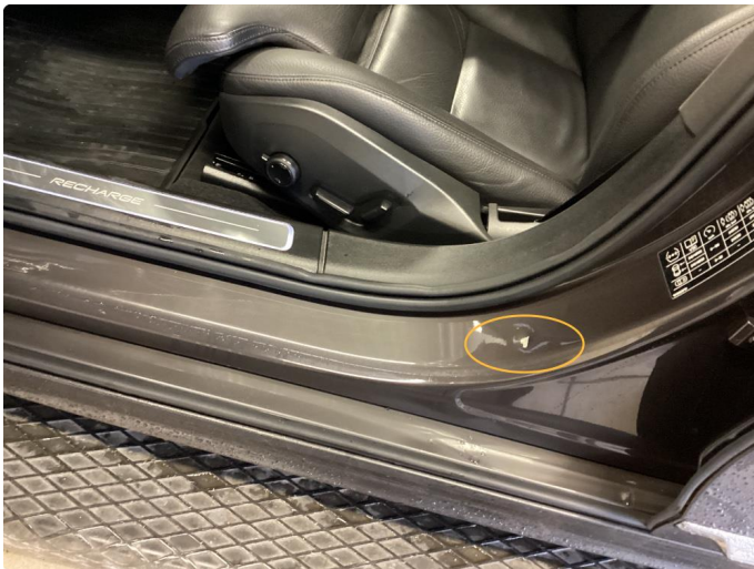
1.1 Bulk med lakkskade. Utført
