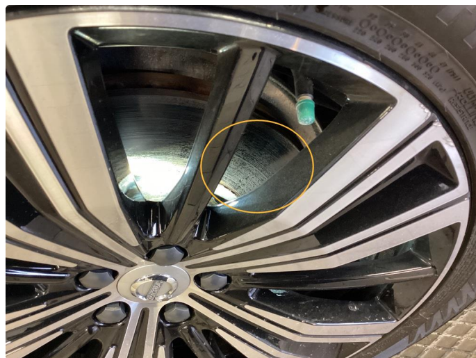
3.1 Mer enn 25% rust.OK
