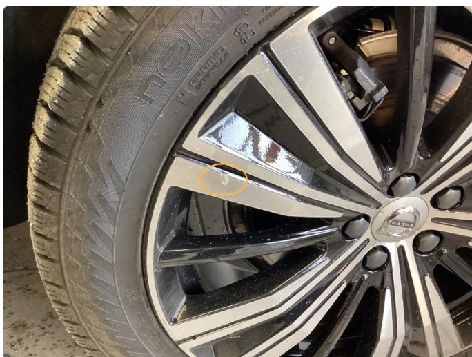
2.4 Kantkjørt felg. Intakt
