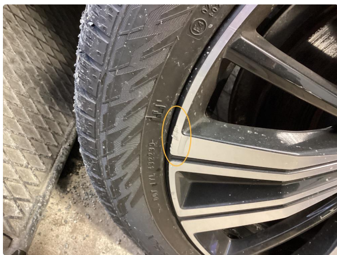
2.4 Kantkjørt felg. Intakt
