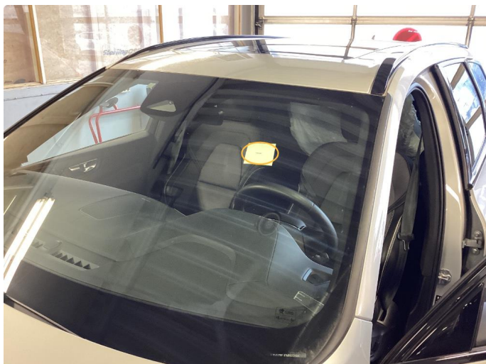
2.5 Steinsprut med sprekk i synsfelt.OK
