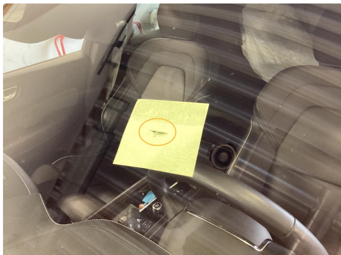
2.5 Steinsprut med sprekk i synsfelt.OK
