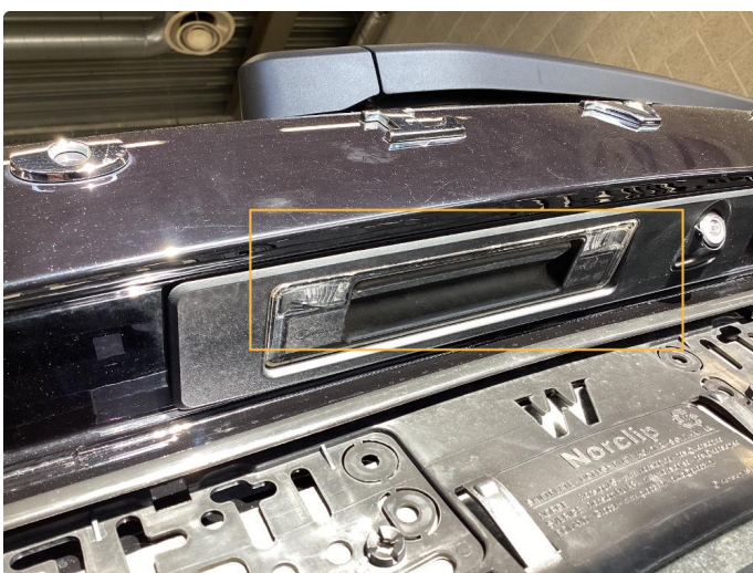
2.1 Skiltlys- skade. Byttet
