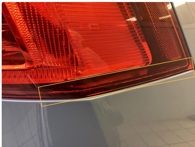
2.2 Krakelering i plast. Byttet
