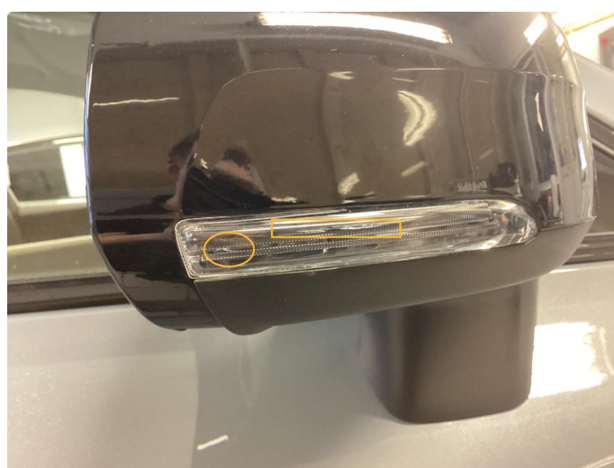
1.3 Blinklys sprukket/krakelert . Byttet
