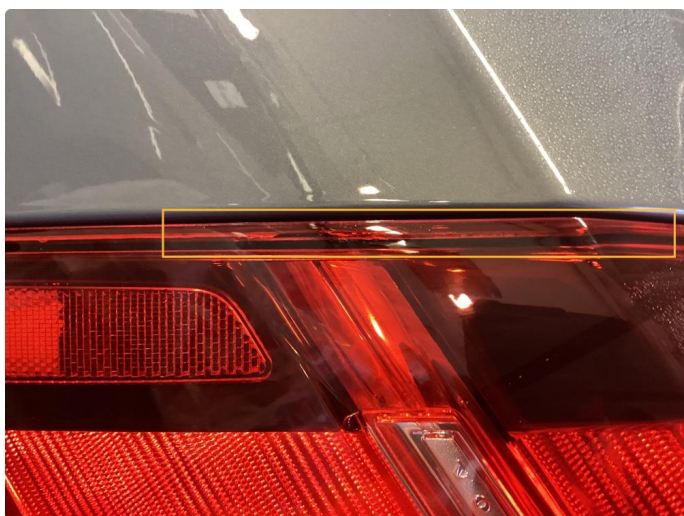
2.2 Krakelering i plast. Byttet
