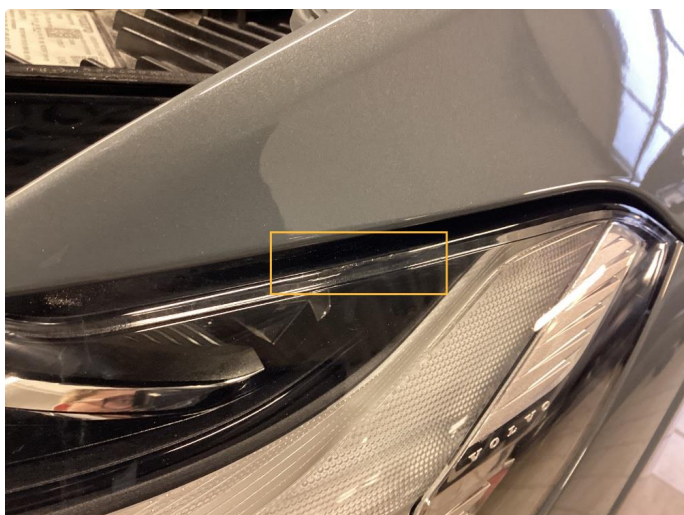
2.1 Krakelering i plast. Byttet
