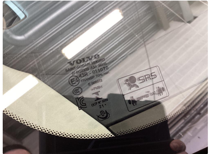
1.2 Steinsprut med sprekk
