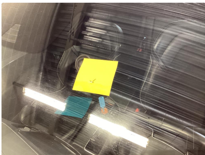
1.4 Steinsprut med sprekk. Byttet
