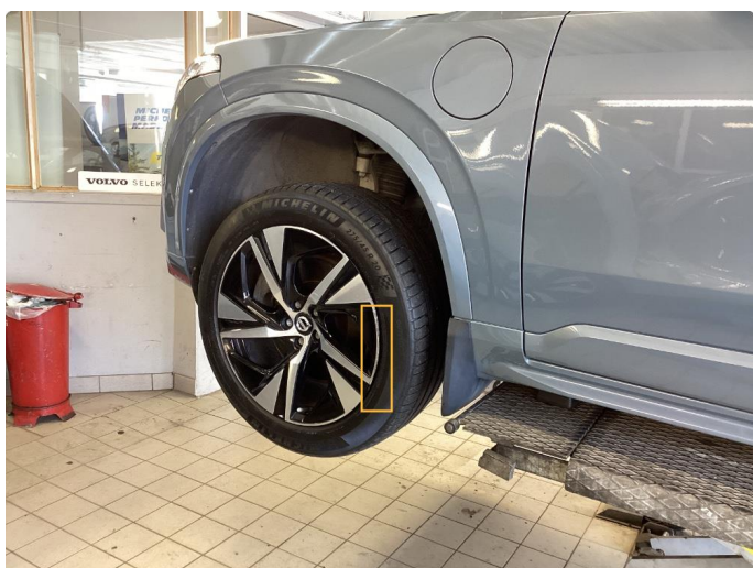
1.3 Kantkjørt felg. Utført
