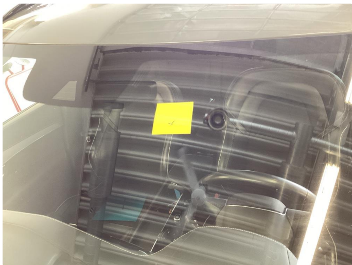
1.4 Steinsprut med sprekk. Byttet
