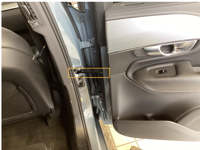
1.1 Dørstopper defekt. Utført
