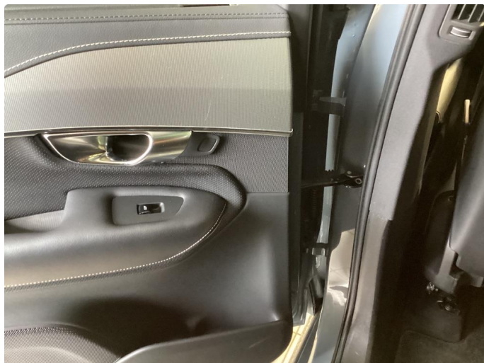
1.1 Dørstopper defekt. Utført
