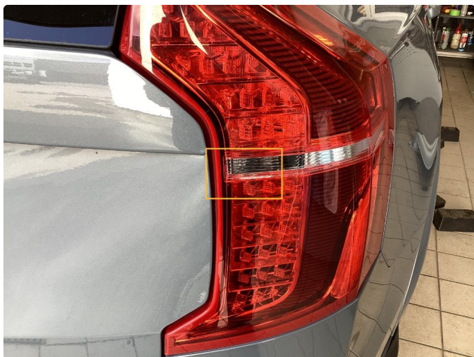
2.1 Defekt / sprukket glass. Utført
