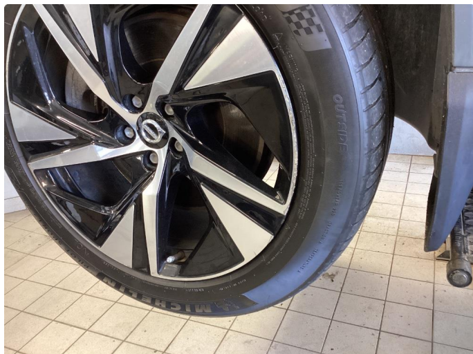
1.3 Kantkjørt felg. Utført
