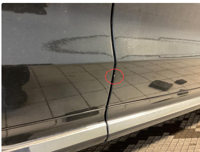
1.4 Bulk med lakkskade.OK
