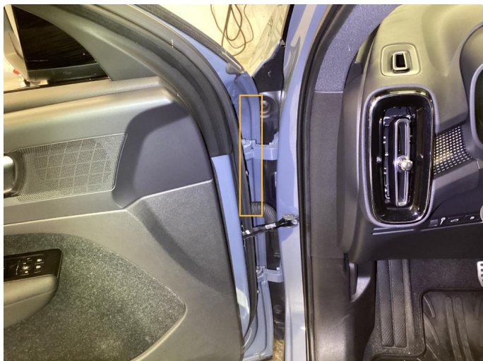
1.1 Rust i fals
