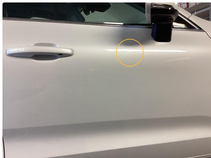
1.1 Bulk med lakkskade.OK
