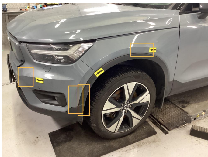
1.3 Ripe(r) ned til grunning. Utført
