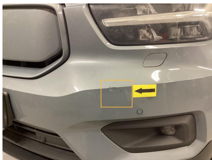
1.3 Ripe(r) ned til grunning. Utført
