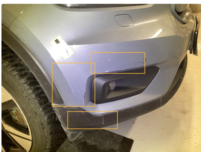
1.3 Ripe(r) ned til grunning. Utført
