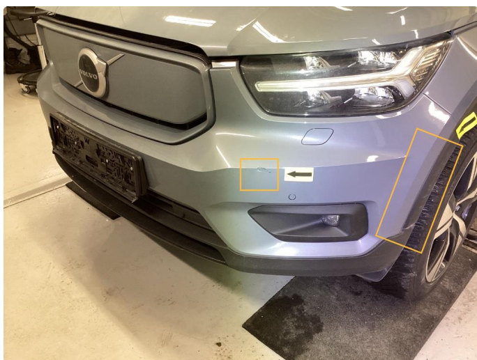
1.3 Ripe(r) ned til grunning. Utført
