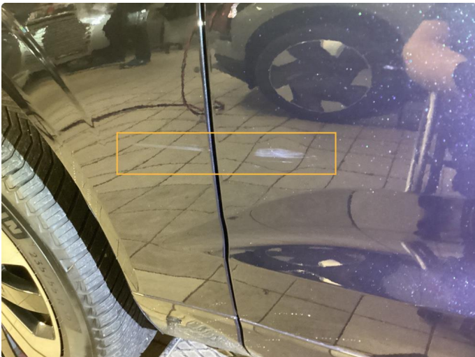
1.2 Bulk med lakkskade.OK
