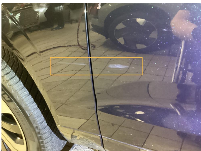
1.2 Bulk med lakkskade.OK
