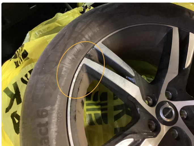
1.3 Skade på felg.OK
