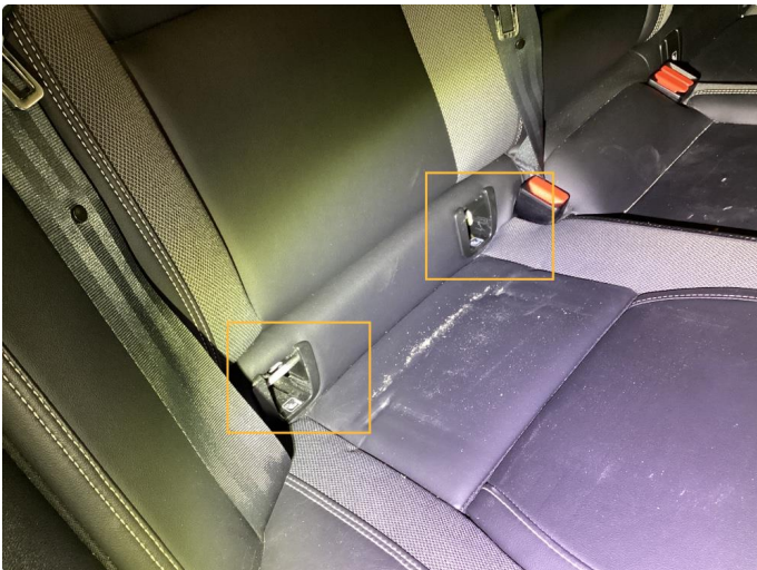
5.2 Mangler deksel over ISOfixfeste. Byttet
