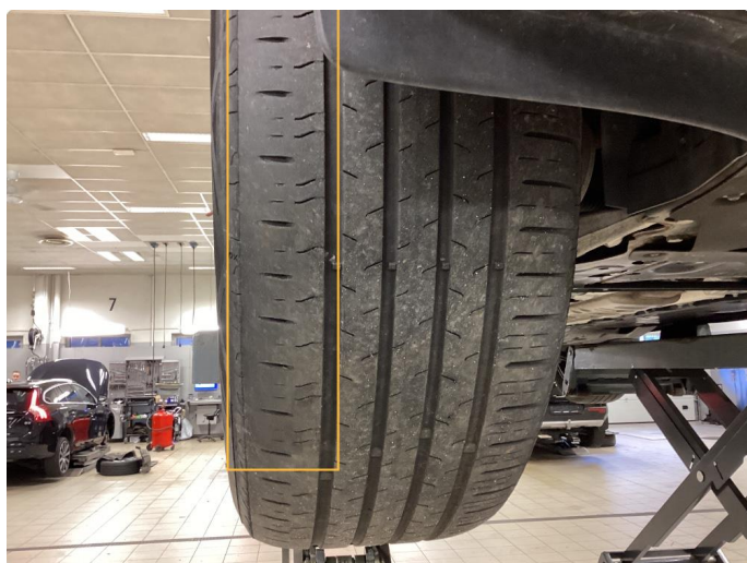
2.6 Skjev slitasje på sommerdekk.
