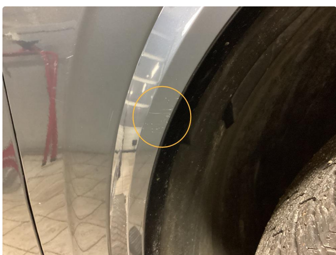
1.2 Skjermutbygger skadet. OK
