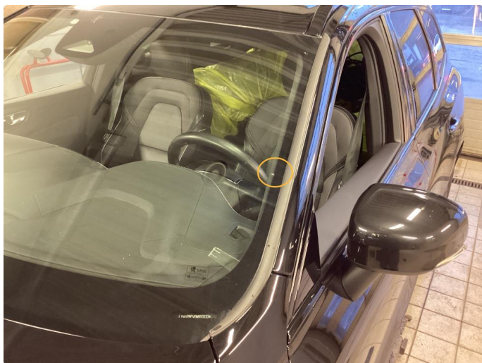
1.9 Steinsprut med sprekk.OK
