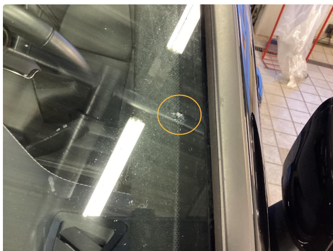
1.9 Steinsprut med sprekk.OK
