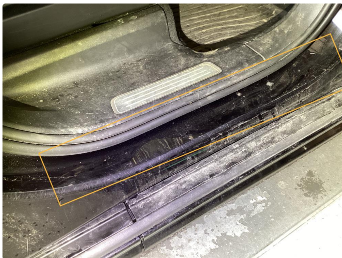
1.5 Bulk med lakkskade. Urført
