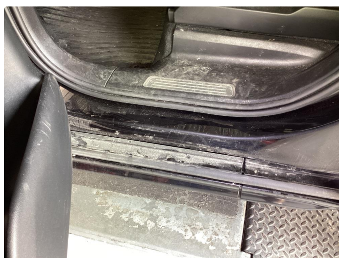
1.5 Bulk med lakkskade. Urført
