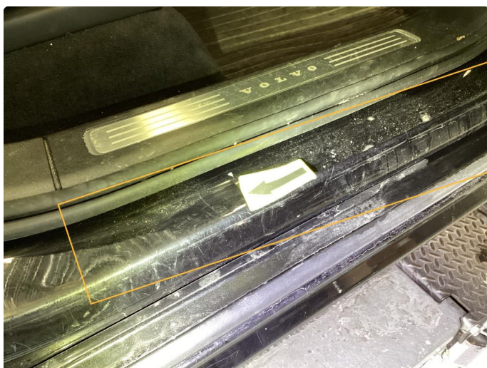
1.5 Bulk med lakkskade. Urført
